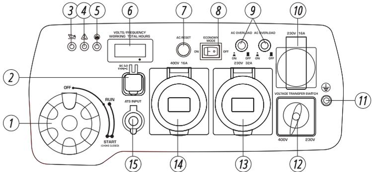
1. Interrupteur du moteur multifonctionnel
