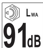
Le niveau de bruit est indiqué à une distance de 7 m. Pour différents modèles, ce niveau est différent. Tous les niveaux sont donnés dans la section « CARACTÉRISTIQUES TECHNIQUES DES GROUPE ÉLECTROGÈNES ».
