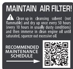
Le filtre à air doit être nettoyé toutes les 50 heures de fonctionnement du groupe électrogène (dans des conditions de pollution accrue toutes les 10 heures).
