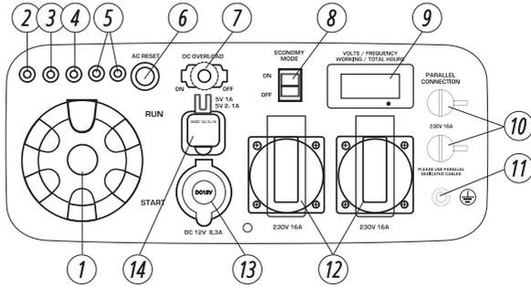
1. Interrupteur du moteur multifonctionnel
